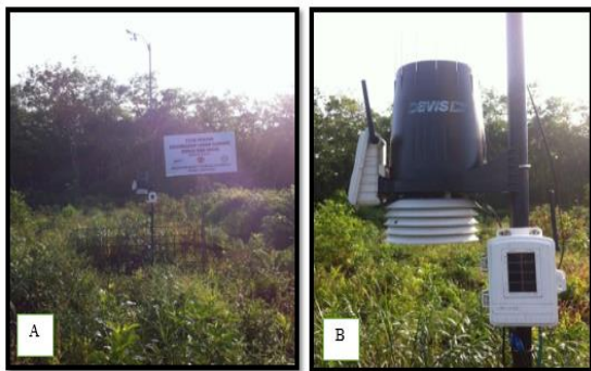
Gambar 7. (Alat pemantau kelembaban di lahan gambut; A) tampak dari kejauhan dan B) tampak dari jarak dekat.
